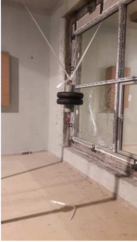
Darbe Noktası 1 - Çatlayan Cam (0,70 m)
